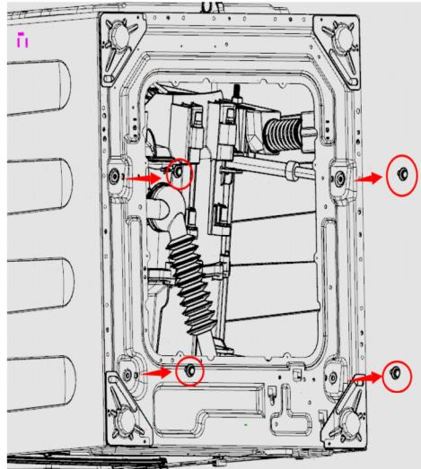
Вытащите барабанный модуль из корпуса.
