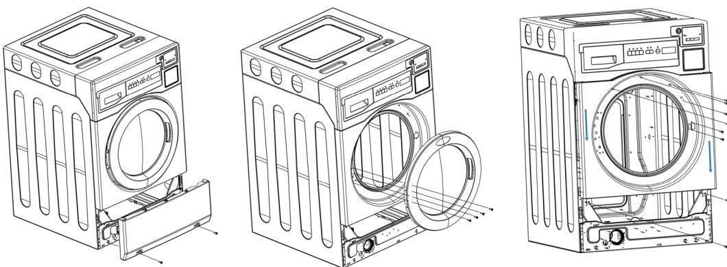
Снимите главную переднюю панель и отсоедините разъем замка дверцы люка.
