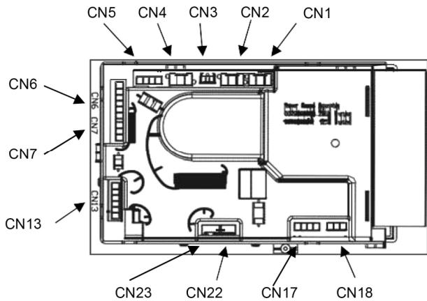
Модуль питания/инвертор U1 расположен на задней стенке машины. Соединения: питание и БЛОКИРОВКА, панель дисплея, барабанный двигатель, водяные клапаны, насос, замок дверцы люка и внешний источник жидкости. U1 крепится к задней части машины четырьмя винтами. U1 не защищён предохранителем.
