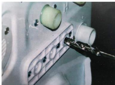
7. С помощью подходящего бита увеличьте отверстия, просверленные на шаге 6, чтобы шланг подачи химических средств легко входил в машину (Рис. 3).
