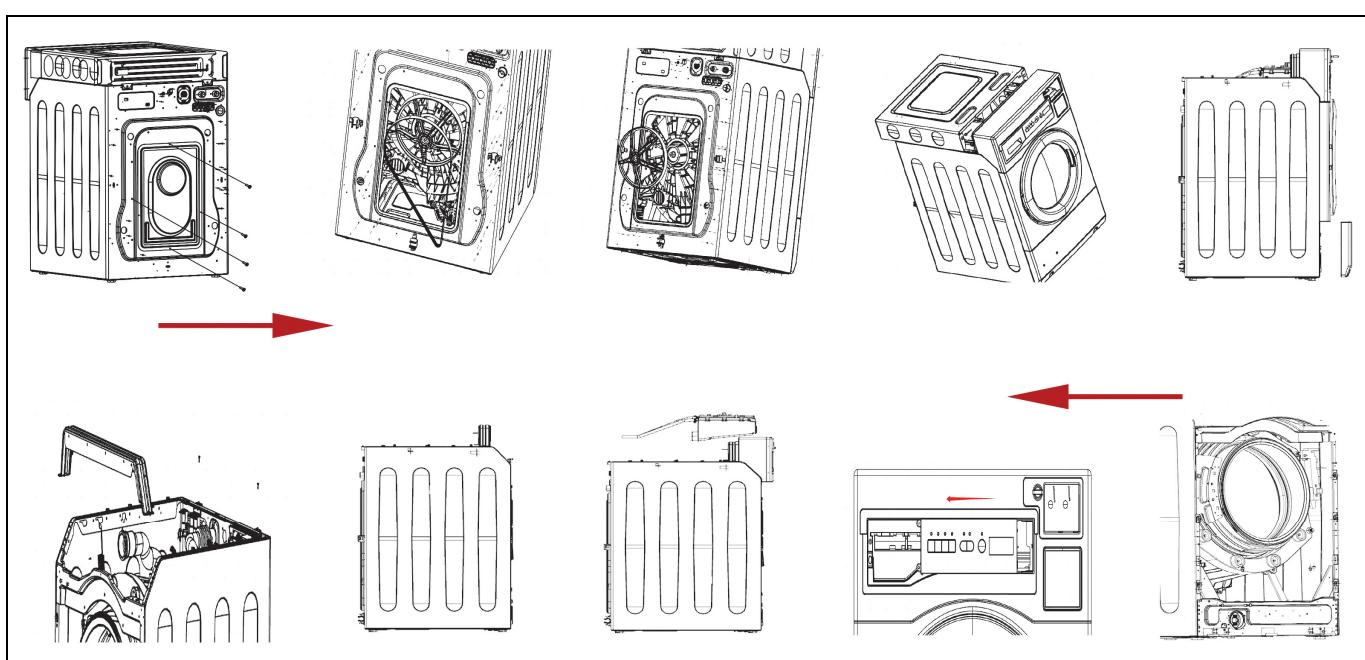
Снимите все электрические устройства и сливной насос.
