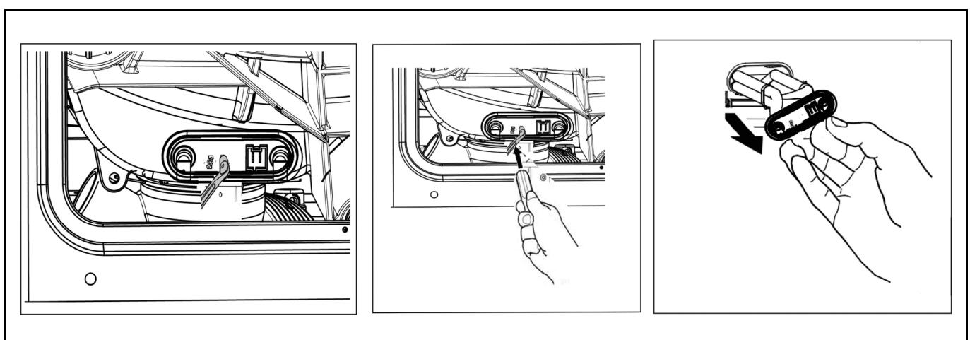
Нажмите на середину нагревательного элемента, чтобы установить фланец на место. Затяните болт. Используйте момент затяжки 6 Нм.
