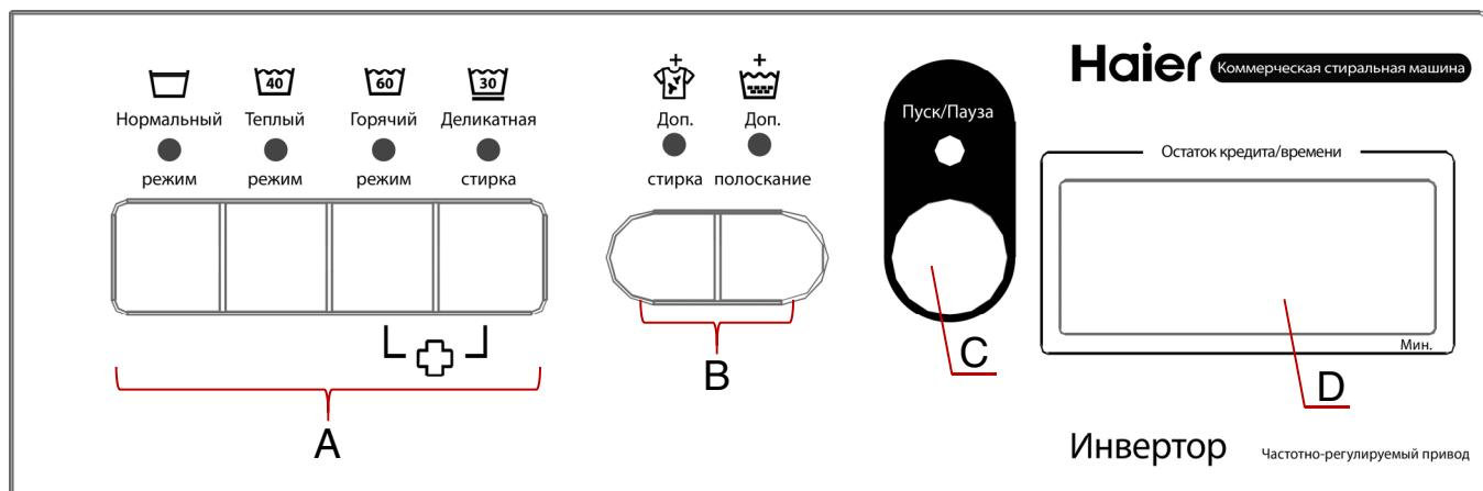
Панель управления состоит из кнопок выбора программы (A), кнопок выбора опций (B), кнопки запуска (C) и дисплея (D). В зависимости от режима, они выполняют разные функции.
