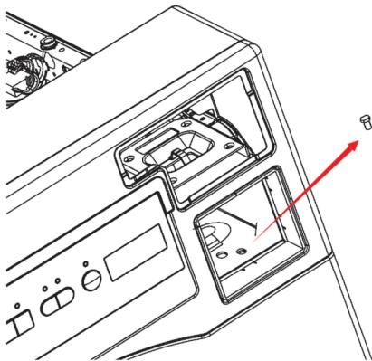
Выкрутите два болта верхней балки.
