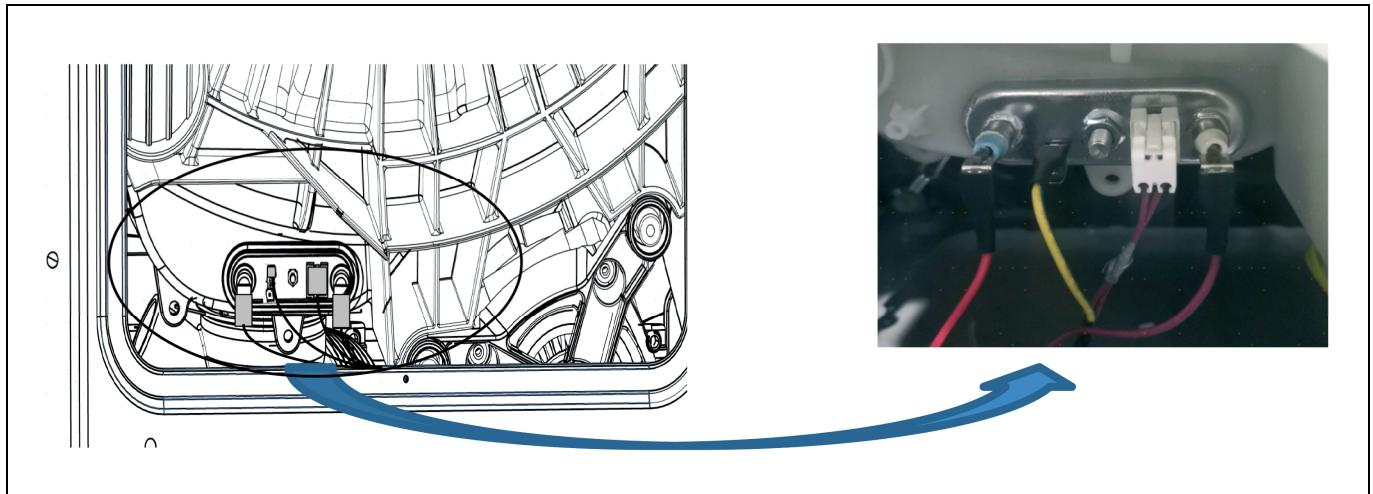
Отвинтите болт на нагревательном элементе и осторожно нажмите на середину нагревательного элемента, чтобы освободить фланец. Снимите нагревательный элемент и вставьте новый нагревательный элемент.
